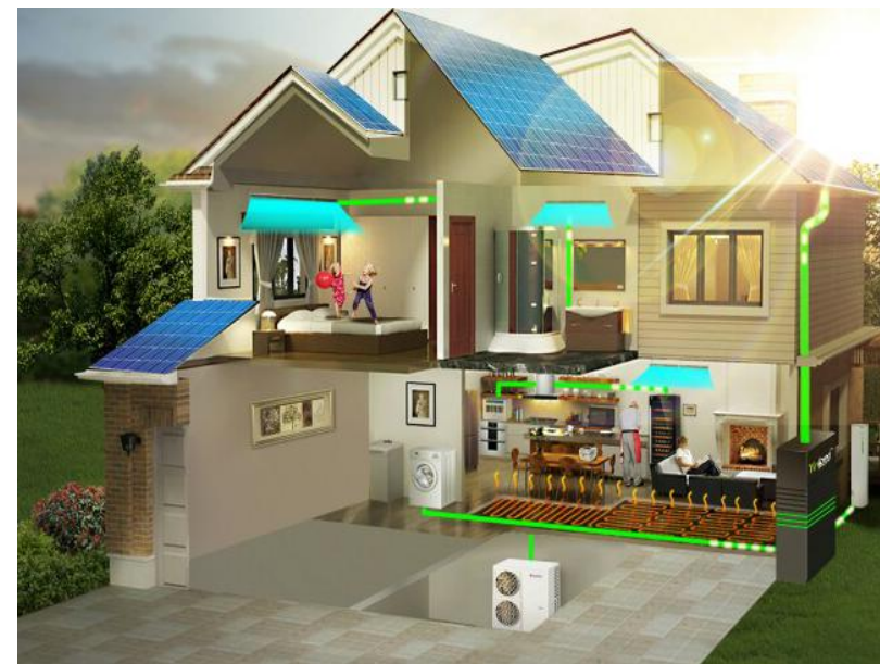
基于光伏空调的直流建筑
